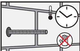
Durante el tiempo de endurecimiento del adhesivo, el ancla no debe ser movida o cargada, se debe de esperar hasta el tiempo de curado. Limpiar inmediatamente las herramientas con **Sika® Limpiador**. El **Sika AnchorFix®-3001** una vez que ha endurecido solo puede retirarse por medios mecánicos. Lavar manos y piel con agua y jabón.
