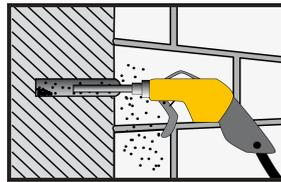
El orificio debe ser limpiado nuevamente con aire comprimido, utilizando una lanza de aire, comenzando desde la parte inferior del orificio. (al menos x 2) hasta que la corriente de aire de retorno esté libre de polvo.
