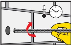
Inserte el anclaje con un movimiento giratorio en el orificio de perforación lleno. Debe salir algo de adhesivo del orificio. Importante: el ancla debe colocarse dentro del tiempo abierto.
