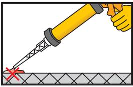
Dispense aproximadamente dos veces la pistola hasta que los dos componentes del adhesivo se aprecien perfectamente mezclados. No usar este material. Liberar la presión de la pistola y limpiar la salida de la boquilla con un trapo.
