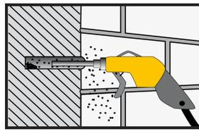
El orificio de perforación debe limpiarse con aire comprimido, utilizando una lanza de aire, comenzando desde la parte inferior del orificio. (al menos x 2) hasta que la corriente de aire de retorno esté libre de polvo.
